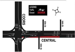
Uno de los carriles en dirección este se cerrará el central del oeste de la calle 65 al este de la calle 64 ° para que las cuadrillas puedan insertar una válvula grande. Uno de los carriles de tráfico en dirección al este permanecerá abierto.
